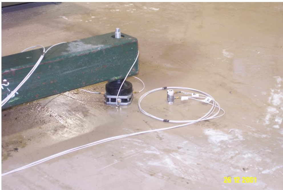
מד תאוצה מוצמד לרצפת מבנה למדידות מודאליות. מד תאוצה מוצמד לרגל מכונה למדידת עירור דינמי לאורך זמן
